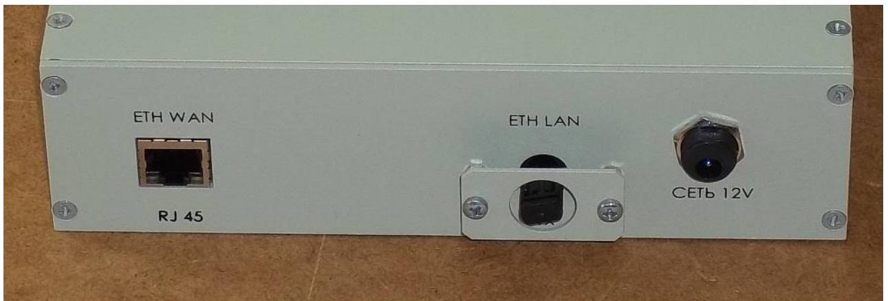
Рис. 6. Задняя панель однонаправленного шлюза «З-Кросс» Исполнение 2.
